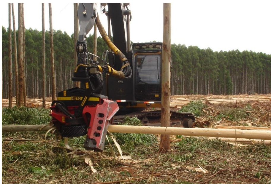
Figura 15.3.2.2-6. Colheita mecanizada realizada pelo trator florestal “Harvester”.
