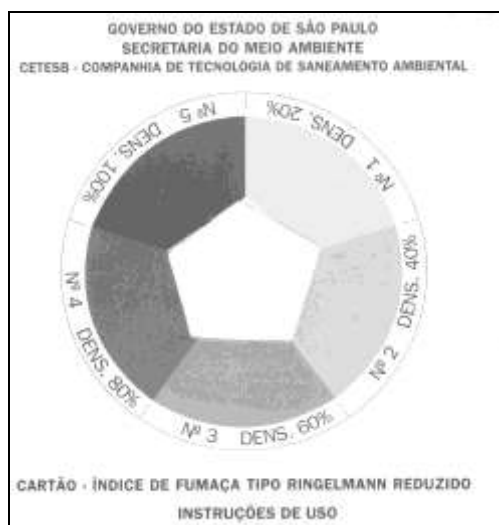
Figura 64 - Escala de Ringelmann Reduzido.
