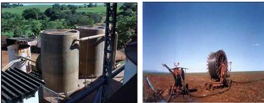
Figura 16 – Torres de resfriamento de vinhaça e aplicação por rolão.
