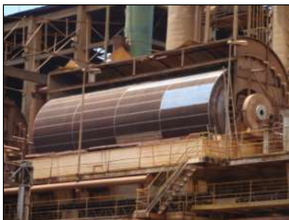
Figura 19 – Filtro rotativo à vácuo
