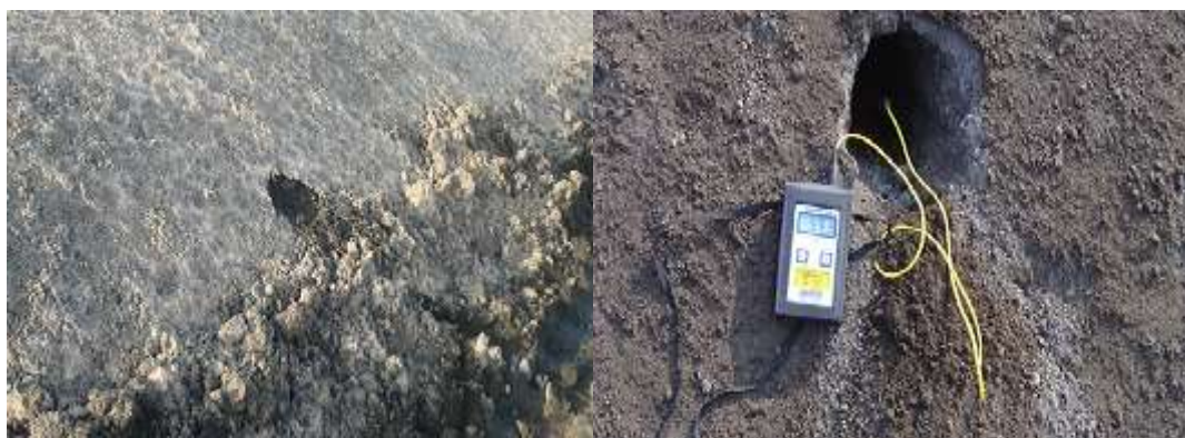
Figura 15 – Crescimento biológico e controle temperatura das leiras.
