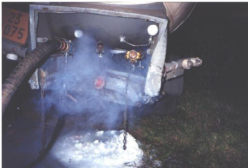
**Foto 9 - A formação de uma nuvem esbranquiçada e gelo indica presença de gás liquefeito**
