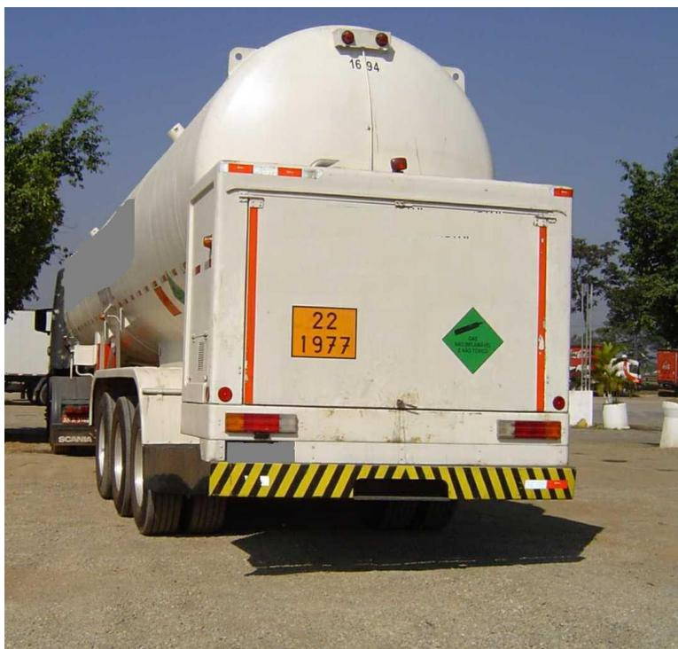
**Foto 12 – carreta com tanque refrigerado para transporte de criogênicos, dotado de capela**
