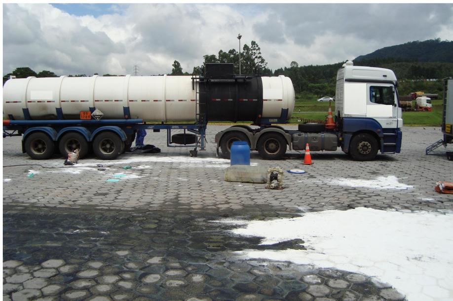
**Foto 13 - carreta revestida para transporte de ácido clorídrico**
