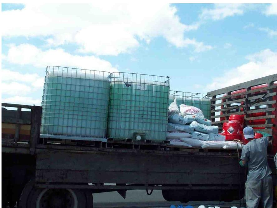
**Foto 16 – IBC de polietileno para transporte de corrosivos**
