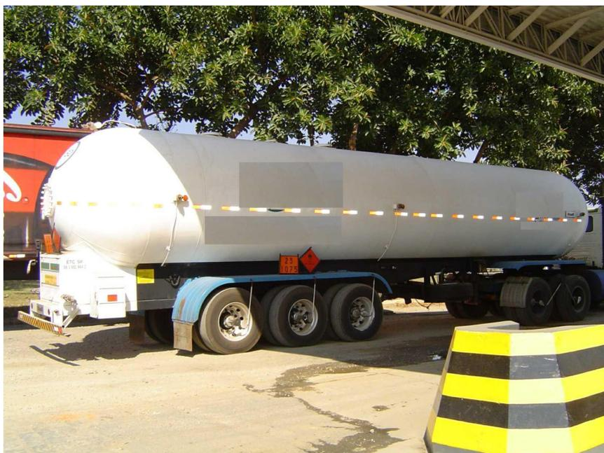
**Foto 11 - carreta com vaso de pressão para transporte de gases liquefeitos pressurizados**
