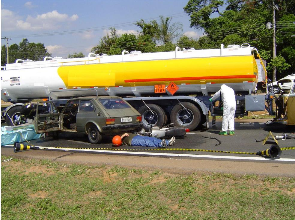
**Foto 14 - carreta compartimentada de aço carbono para transporte de combustíveis**
