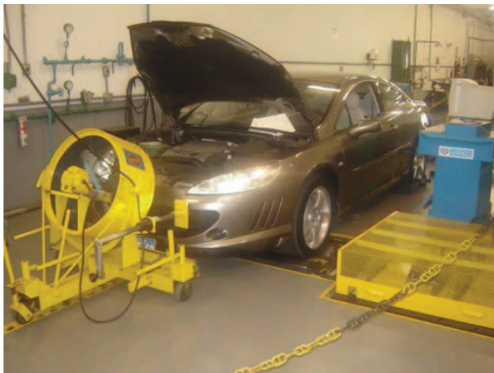
Fotografia 6 - Laboratórios de emissões: dinamômetro chassi Otto
