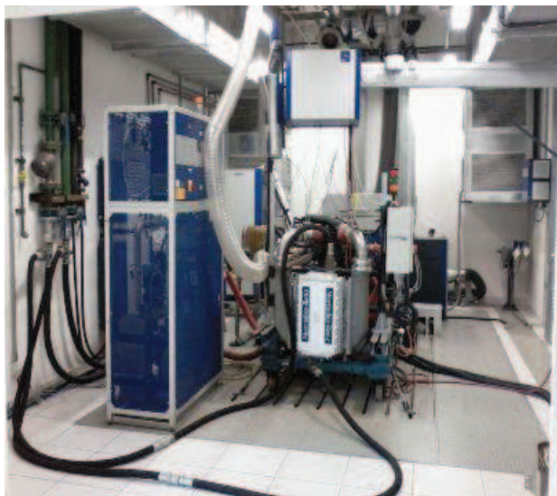
Fotografia 4 - Laboratórios de emissões: dinamômetro de bancada
