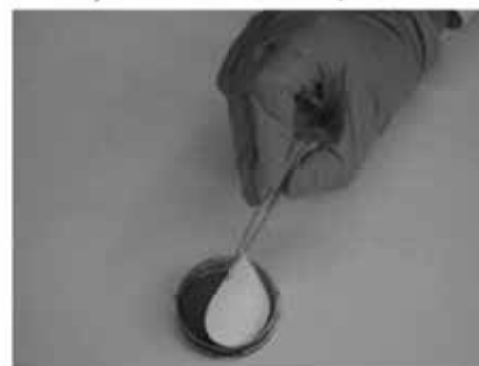
Figura 2- Colocação da membrana filtrante na superfície do meio de cultura
