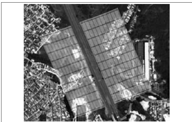
Figura 12 – Assumindo-se que seja foco de análise a pista da direita, a lateral da área de influência oposta terá largura menor que 300 metros, pois a medição deverá ser feita a partir do bordo da via em análise
