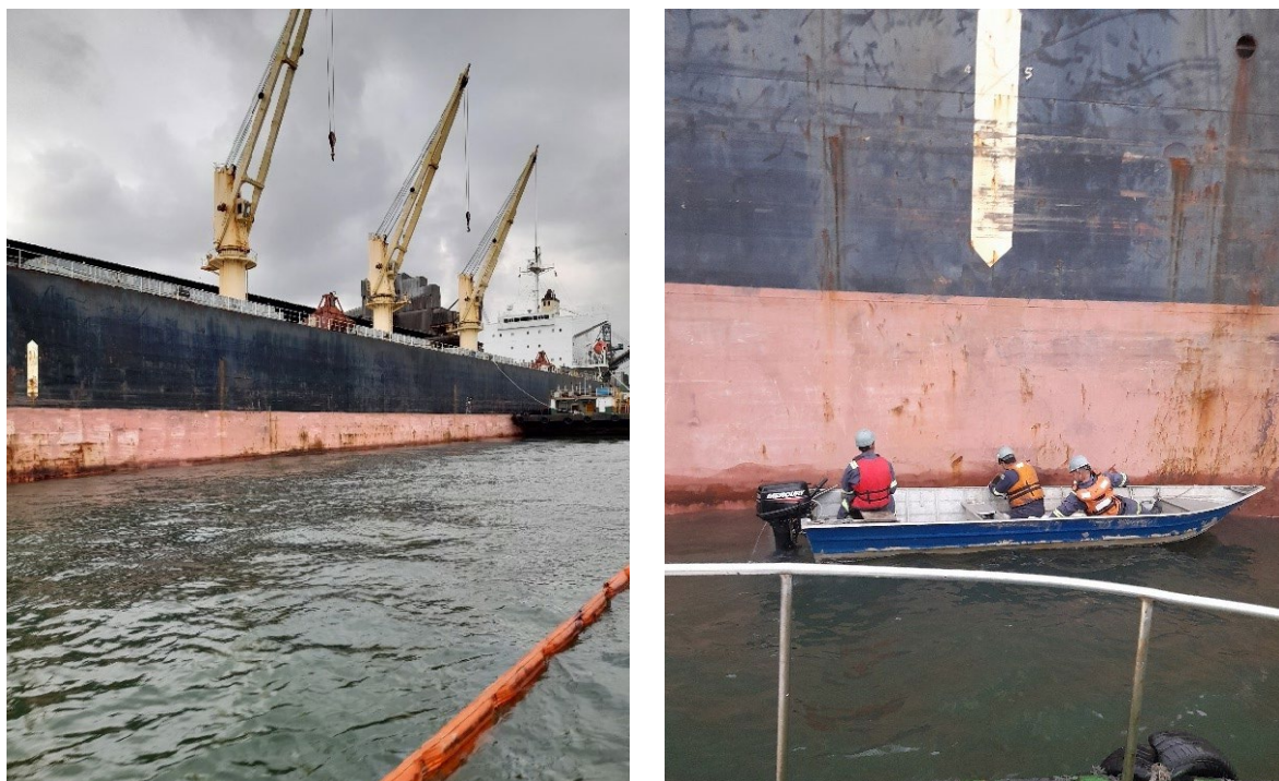
Figura 5.2 – Barreira de contenção aplicada ao redor do navio para propiciar o cerco preventivo para o caso de vazamento durante as operações de abastecimento (a) e detalhe da limpeza realizada ao longo do casco do navio de modo a evitar a contaminação das águas quando de sua partida do porto (b)
