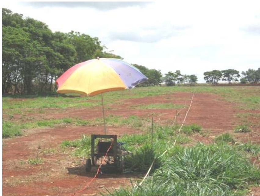
Figura 106. Estaqueamento do perfil para a realização do ensaio de caminhamento elétrico no aterro de Luiz Antônio
