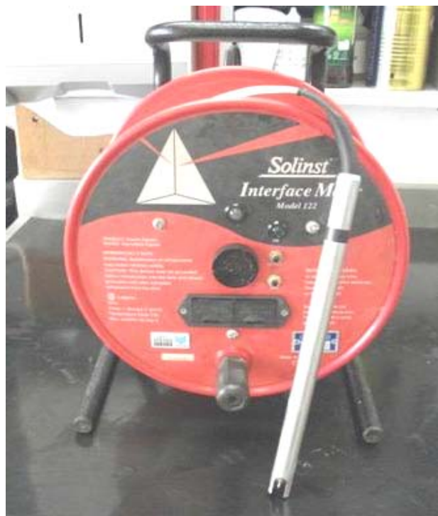
Figura 52. Medidor de nível.
