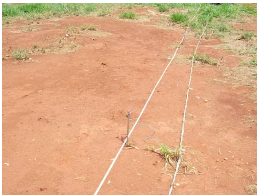
Figura 107. Detalhe dos eletrodos cravados no solo para a realização dos ensaios
