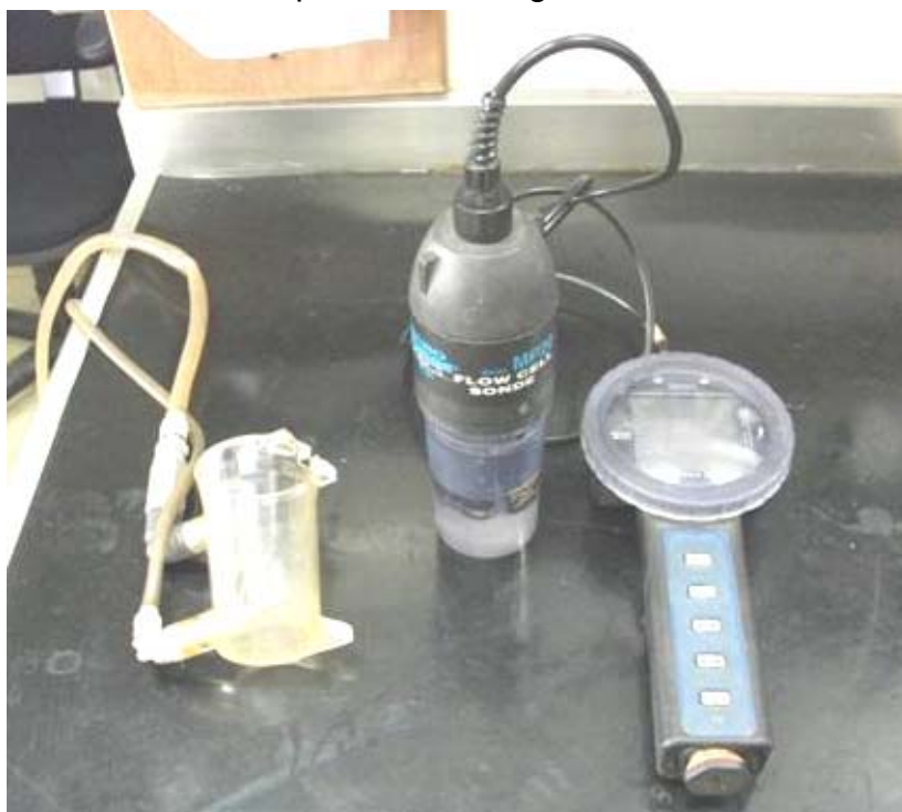
Figura 53. Célula de fluxo utilizada para o monitoramento dos parâmetros indicativos da qualidade da água durante a amostragem.
