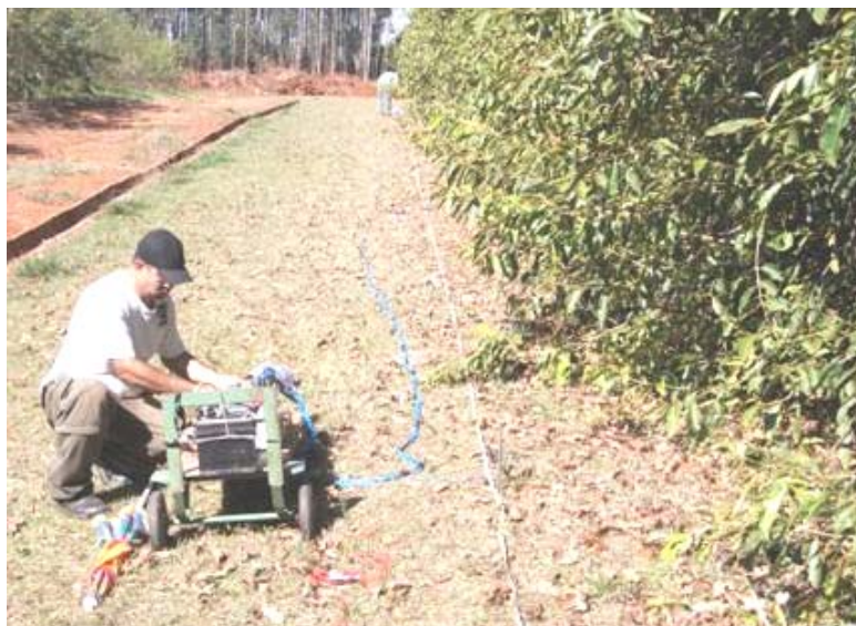
Figura 64. Estaqueamento do perfil para a realização do ensaio de caminhamento elétrico no aterro de Angatuba
