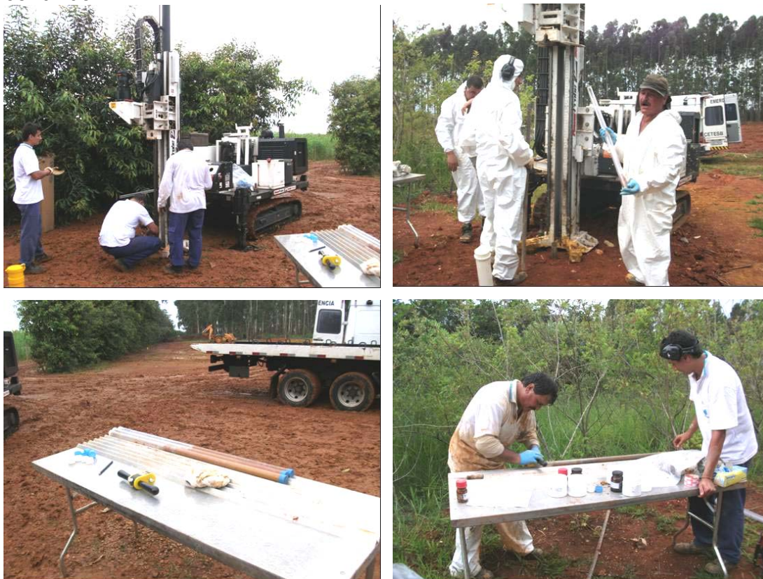
Figura 42. Amostragem de solo, utilizando o método da cravação contínua
