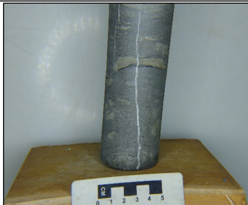
Foto 4a: testemunho de sondagem mostrando argilito com clastos irregulares de arenito fino. Grupo Itararé, Bacia do Paraná, era glacial neopaleozóica.
