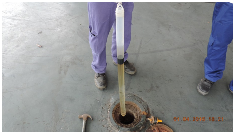
Figura 1.6-4 – Inspeção em poço de monitoramento para verificação de combustível em fase livre
