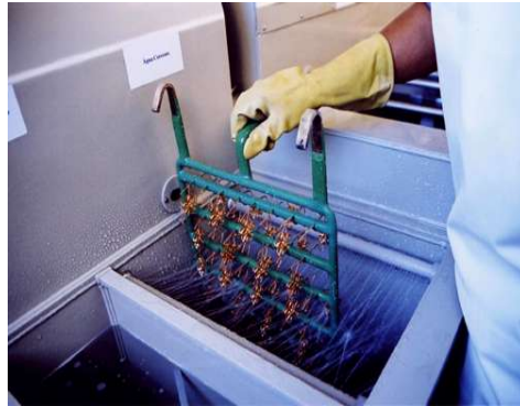
Fig.18 - Enxágue por spray acionado por fotocélulas
