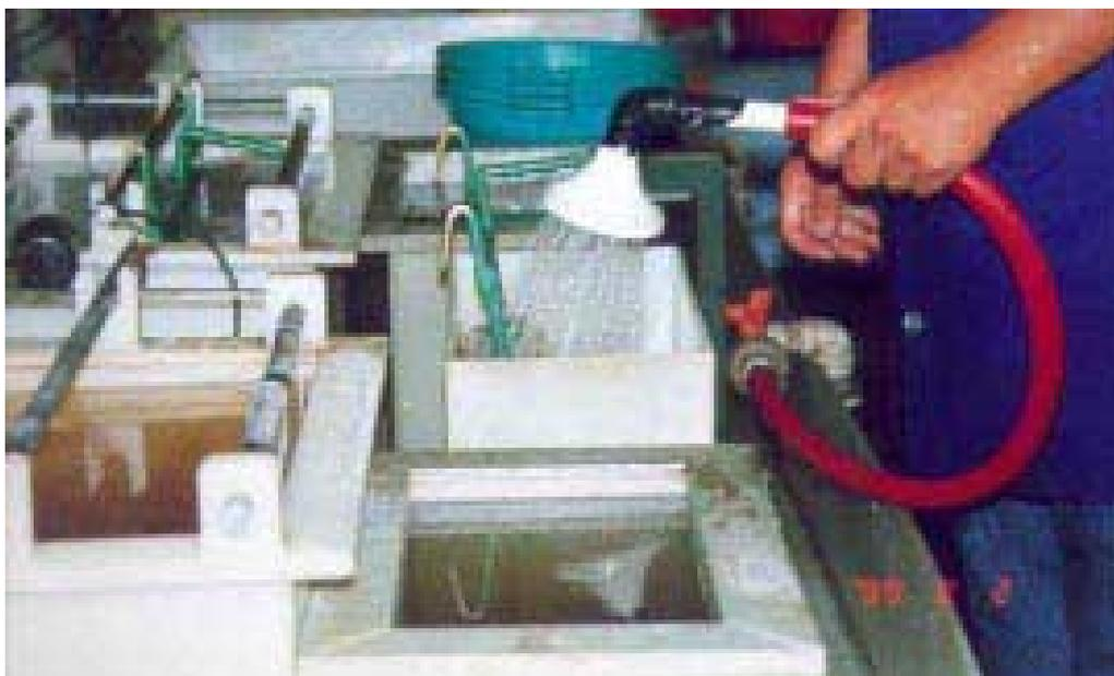
a) Chuveiro com orifícios de diâmetro grande, acionado por válvula fixa.
