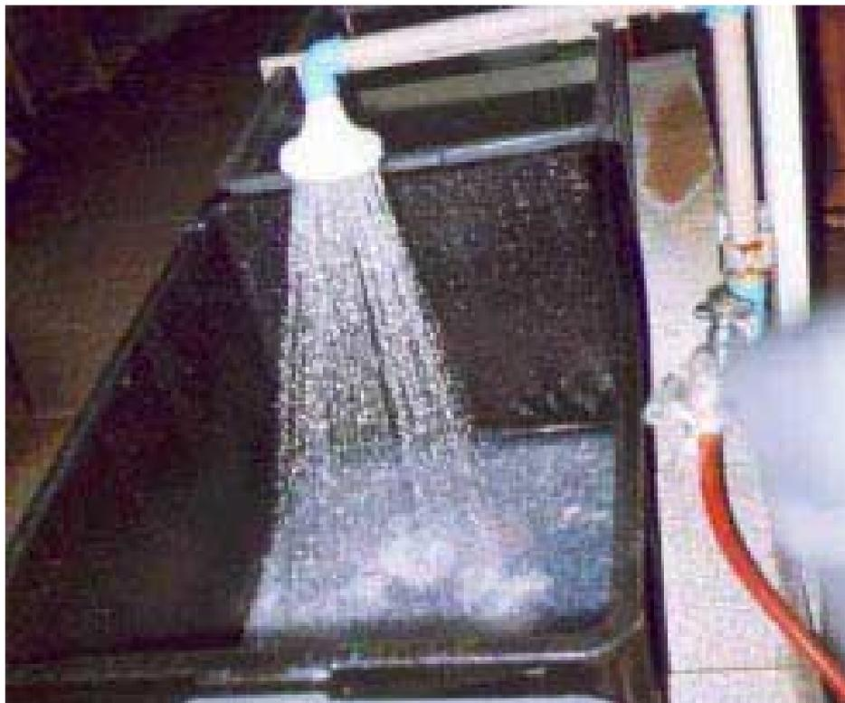
**Inconveniente: gasto excessivo de água, devido principalmente ao tamanho dos orifícios e a distância entre a válvula e o operador.**
