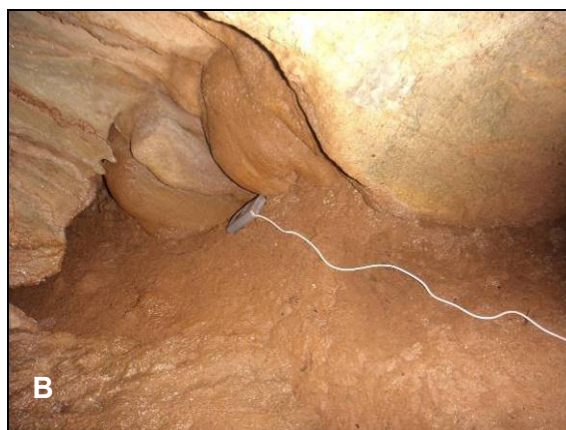
Figura 45 - Em A) detritos orgânicos depositados no interior da cavidade e em B) termo higrômetro utilizado para as medições de umidade e temperatura no interior da cavidade.
