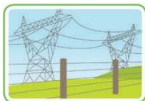
Cercas de arame e porteiros desde que aterrados para não ter risco de choque;
