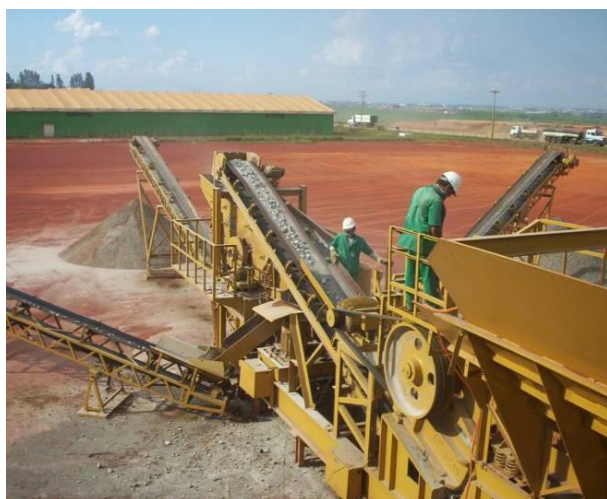
Sistema de correias transportadoras.
