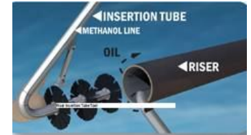
16/mai - Inserção de tubulação no Riser e início do 2º poço
