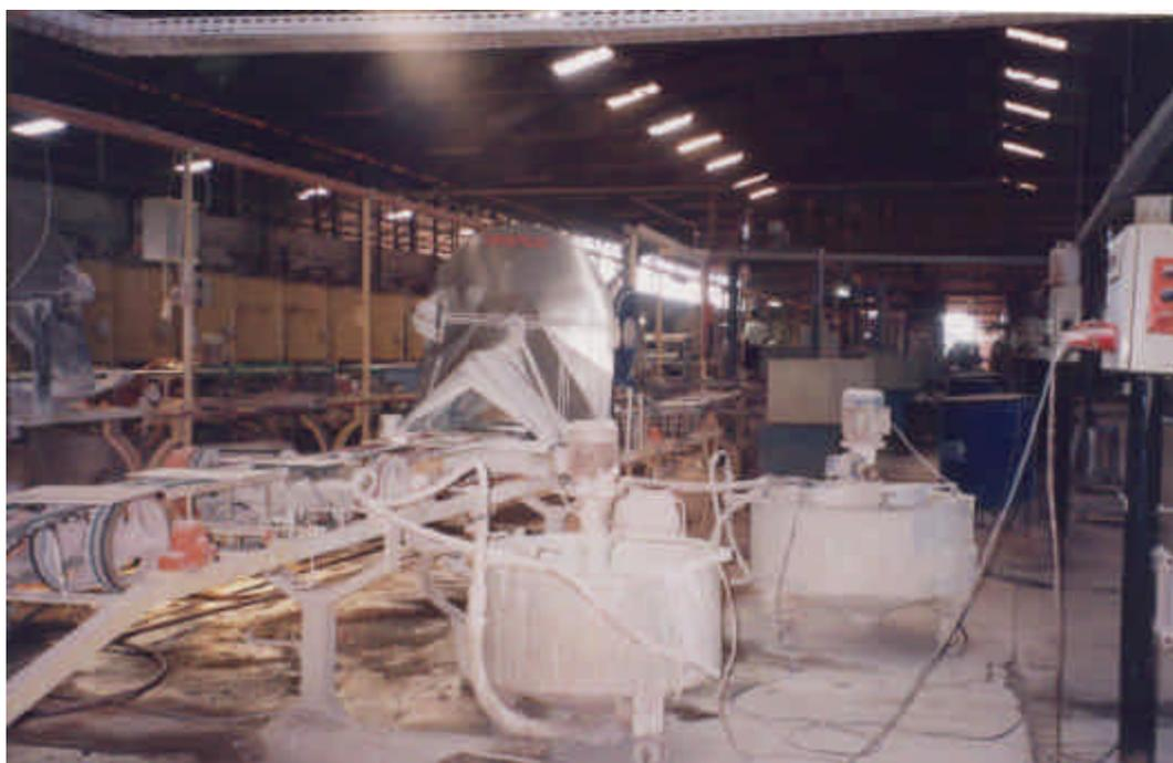
**Figura 3.2 – Aplicação de engobe de fundo e cobertura**
