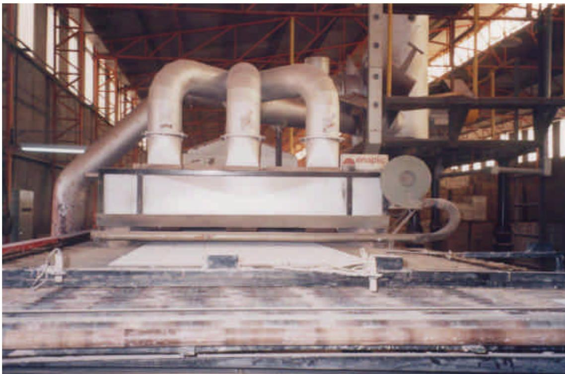
**Figura 3.4 – Detalhe do Sistema de Ventilação na entrada do forno (zona de queima)**
