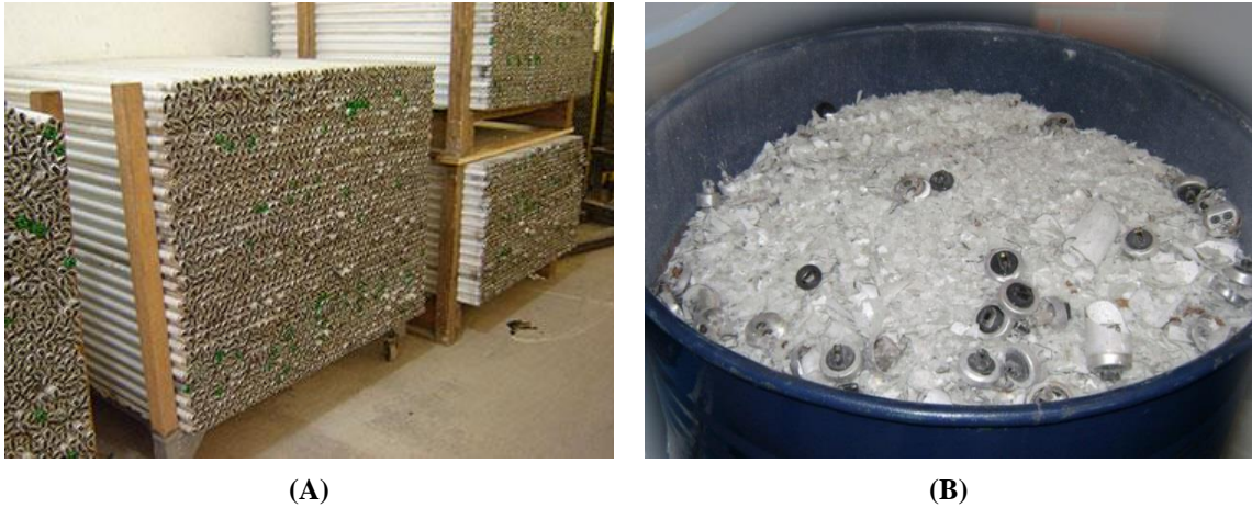
Figura 3 – Armazenamento das lâmpadas íntegras (A) e das lâmpadas trituradas contidas em tambor (B).
