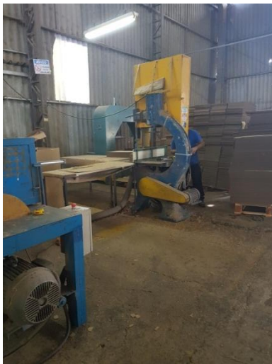
Figura 38 – Setor de acessórios, máquina riscadora em operação
