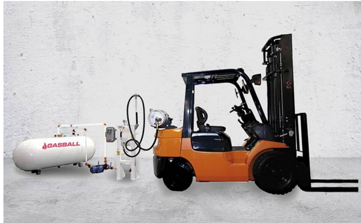
Figura 10 - Abastecimento de GLP na empilhadeira
