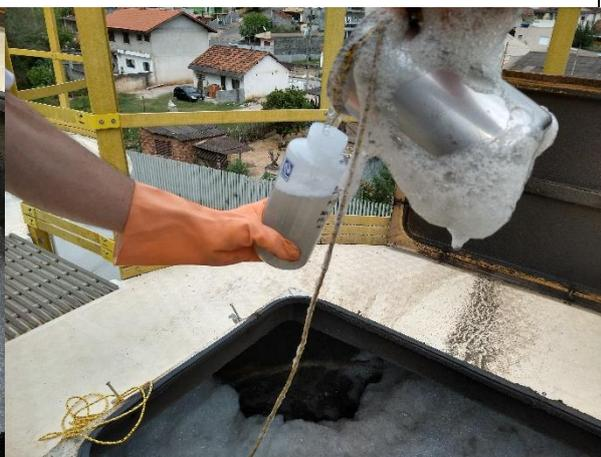
Coleta do efluente da saída do reator aeróbico
