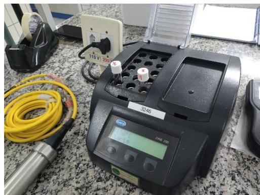
Equipamento HACH DRB 200 para proporcionar a reação
