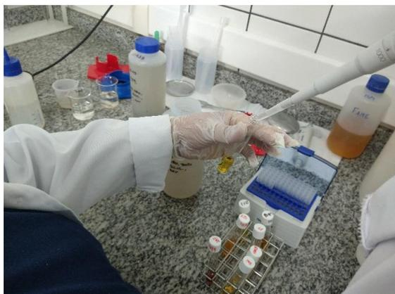
Pipeta volumétrica inserindo 2mL da amostra por frasco com reagentes
