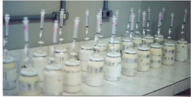
**Figura 2.** Frascos utilizados nas incubações para coleta de  $N_2O$ .
