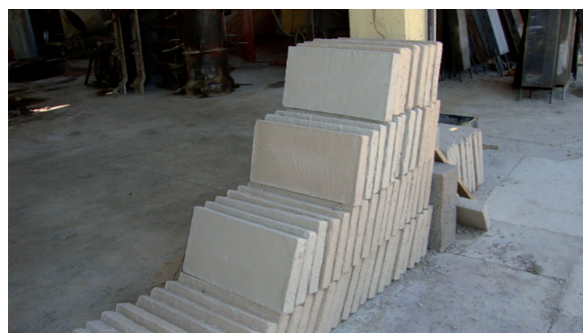
Aproveitamento de agregado reciclado.
