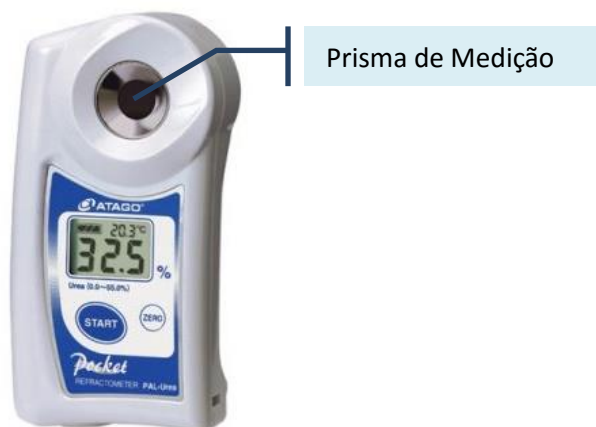
Figura 4 - Refratômetro para medição de concentração de Ureia (PAL Urea – ATAGO)
