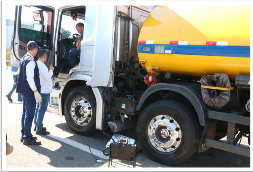
Fotografia 3 – Fiscalização de opacidade
