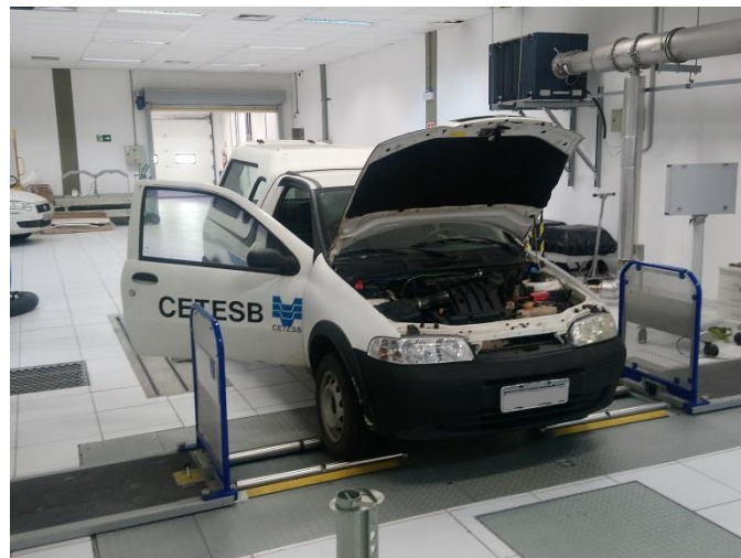
Figura 3 – Dinamômetro de chassi do laboratório CETESB
