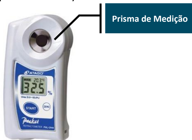
Figura 2 - Refratômetro para medição de concentração de Ureia (PAL UREA – ATAGO)
