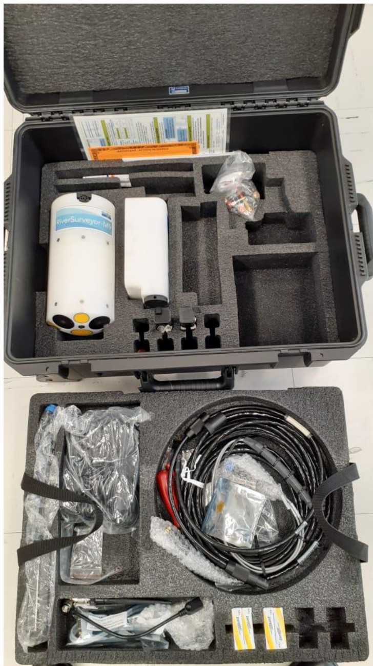
Foto 8 – Maleta com o medidor de vazão e acessórios.
