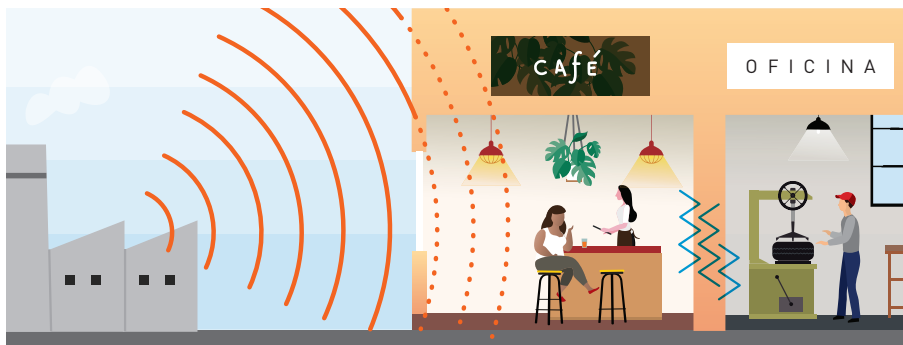
FIGURA 25 TRANSMISSÃO SONORA VIA AÉREA E VIA ESTRUTURAL
