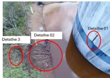
Imagem aérea 002 tanque de Mel com solda - detalhe 01, ravinas na contenção - detalhe 02 e árvores queimadas - detalhe 03.
