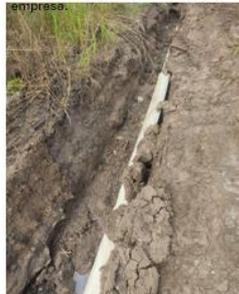
Foto 22 - Tubo de PVC amassado, dentro de vala por onde passou efluente.
