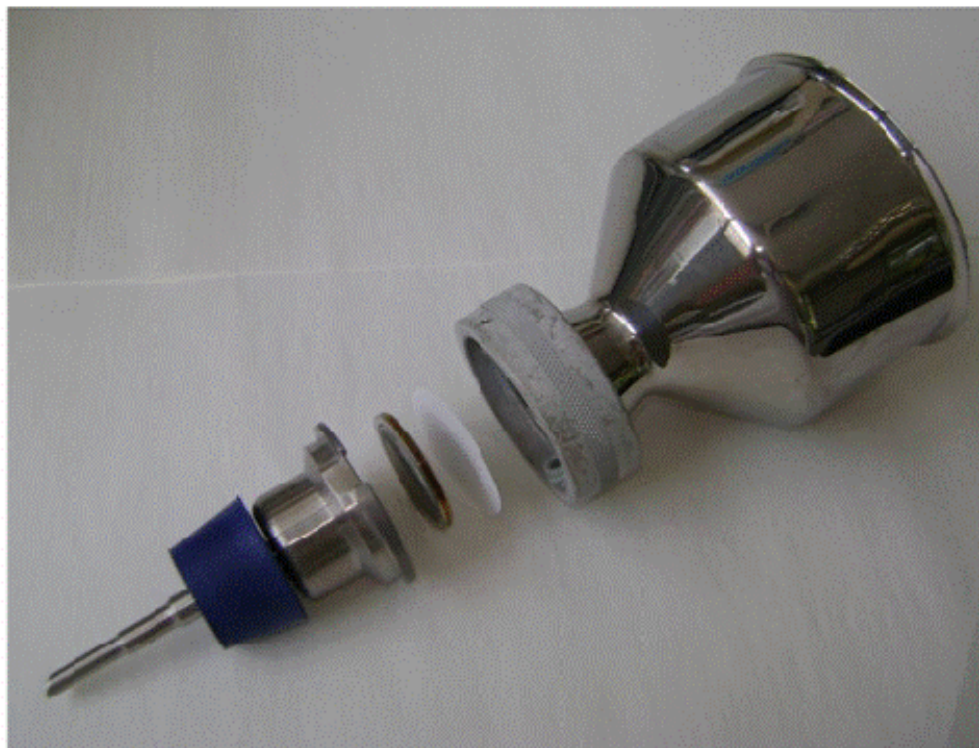
Figura 1 - Vista geral dos diversos componentes da unidade de filtração
