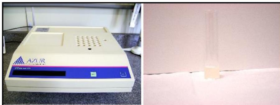
Figura 2 – Sistema analisador de toxicidade e cubeta de vidro
